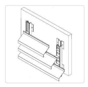
Profil aluminium semi-lourd extrudé destiné à être fixé directement sur un mur existant ou une structure en acier. Le type LD.0195 est autoportant avec des points de fixation avec un écartement maximal de ± 600 mm sur la hauteur.\*
